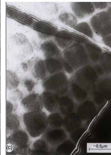
Précipités \text{Ni}_3\text{Al} (10-100 nm)
